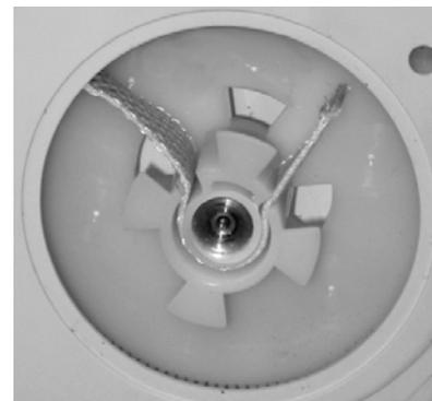
Lösen Sie mit einem Schraubendreher die Schraube der Abdeckung des Gurtwicklers. Drehen Sie die Schraube soweit heraus dass Sie mit der Schraube die Wickelrad-Abdeckung abheben können. Im Gerät erkennen Sie die Wickelscheibe, in deren Mitte sich die Führung zur Befestigung des Gurtbandes befindet.
