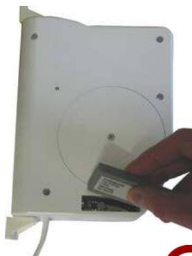
Optional kann ein Funkmodul eingesteckt oder der Sonnensensor eingesteckt werden.
